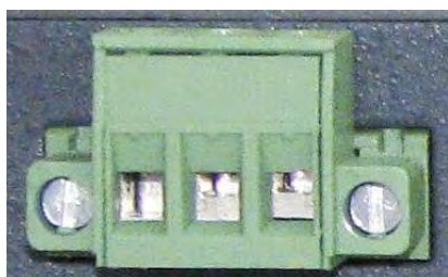
Рис. 26: Проводной разъем, вставленный в разъем питания
