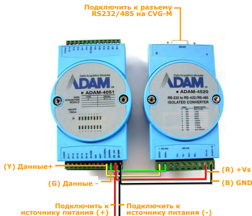
Рис. 15: Подключение модуля к преобразователю, CVG-M, и источнику питания
