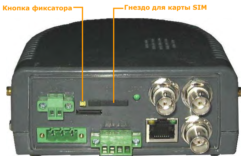
Рис. 21: Гнездо для карты SIM и кнопка фиксатора
