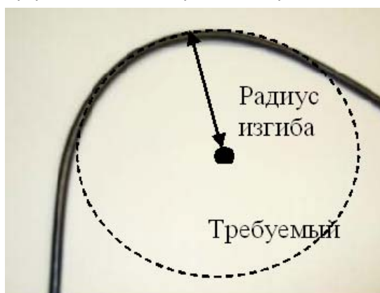
Рисунок 5 Радиус изгиба кабеля
