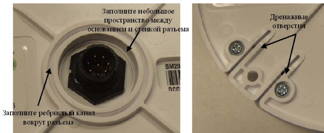
Рисунок 8 Нанесение водоотталкивающего герметика (слева) и дренажные отверстия (справа)
