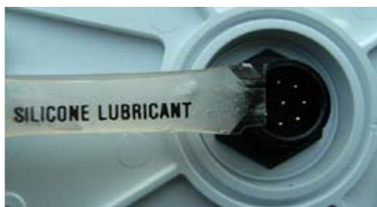
Рисунок 10 Нанесение силиконовой смазки
