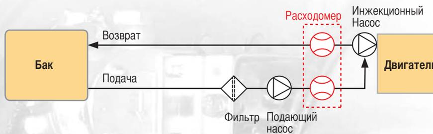
Рис. Система измерения расхода дизельного топлива
