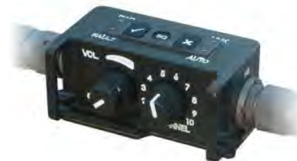
Рисунок 1.2: DRS-micro – VRCU (модуль контроля переменной скорости), устанавливает соединение через шлюз.
