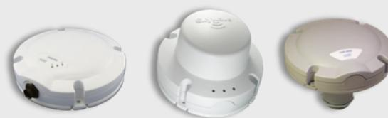
**Серия SureLinX:** Эти терминалы объединяют в себе спутниковую связь с возможностями GSM/GPRS, что делает их идеальными для управления и мониторинга любых объектов. Находясь в зоне сотовой связи, терминал SureLinX передает данные через GPRS. В зонах, где сотовая связь недоступна, он переключается на спутниковую связь, тем самым обеспечивая непрерывное покрытие и низкую эксплуатационную стоимость. Предлагается модель со встроенным приемником ГЛОНАСС.
